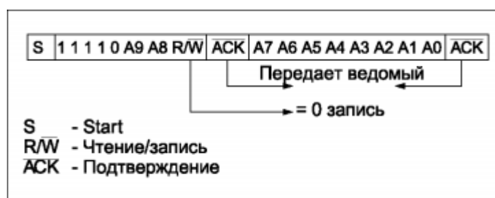
Рис. 1.18. Формат 10-розрядної адресації
