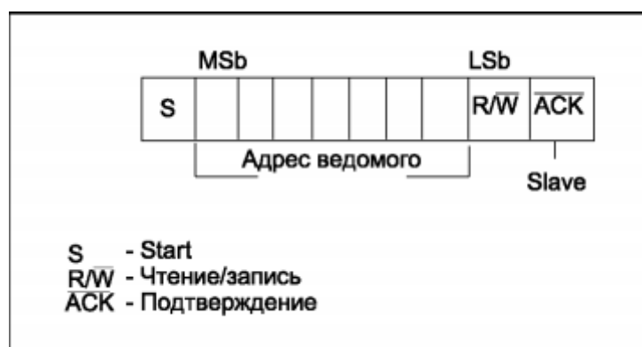
Рис. 1.17. Формат 7-розрядної адресації
