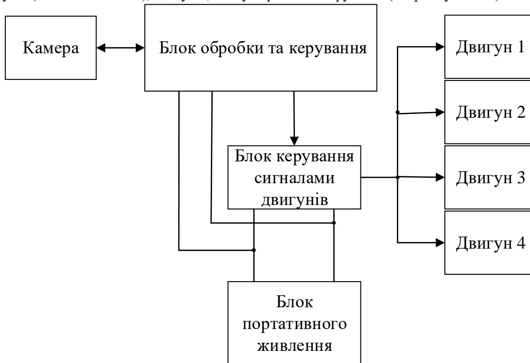
Рис. 1. Функціональна схема взаємодії апаратної частини моделі самокерованого транспортного засобу.
